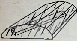
Fig. 9 - Zó wordt een buiger-element uit het kristalblok gesneden
